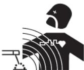
Elektrischer Strom verursacht beim Durchfluss durch einen Leiter elektrische und magnetische Felder (EMF). Der Schweißstrom produziert ein elektromagnetisches Feld um den Schweißstromkreis und um das Schweißgerät herum.
