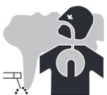
Beim Schweißen entstehender Rauch, Gas und Staub sind gesundheitsschädlich. Eine ausreichende Lüftung ist vorzusehen, in manchen Fällen ist eine Luftzufuhr erforderlich. Im Falle einer unzureichenden Belüftung kann eine Frischluftmaske eine Lösung sein. Effizienz der Luftzufuhr gemäß Sicherheitsnormen überprüfen.
