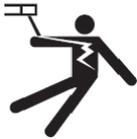
Das Gerät darf nur an einem Anschluss mit vorschriftsmäßig angeschlossenem Schutzleiter betrieben werden. Die in der abgebildeten Tabelle empfohlenen Sicherungsgrößen sind zu verwenden. Eine elektrische Entladung kann die direkte oder indirekte Ursache für einen ernsten, sogar tödlichen Unfall sein.
