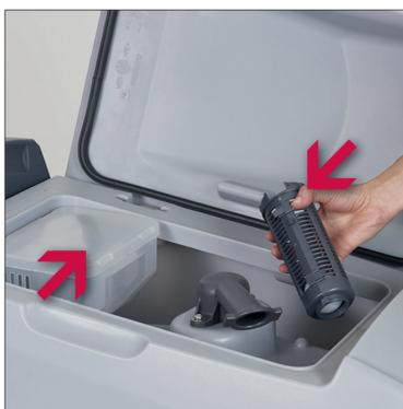
2. Öffnen Sie den Schmutzwassertank und prüfen Sie, ob der Grobschmutzkorb und das Sauggitter mit Schwimmer sauber und funktionsfähig sind.
