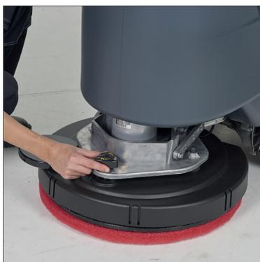
1. Überprüfen Sie den Geradeauslauf der Maschine, falls erforderlich justieren Sie mit dem vorderen Drehknopf nach.
