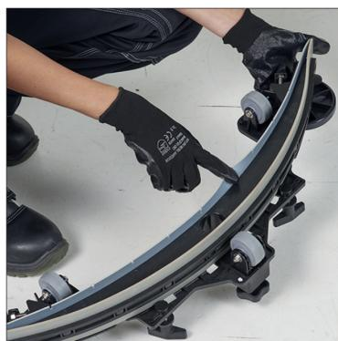
3. Prüfen Sie, ob die Saugleisten beschädigt oder verschmutzt sind.
