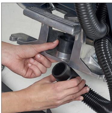
1. Prüfen Sie, ob der Saugschlauch richtig angeschlossen und gereinigt ist.
