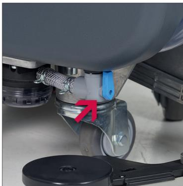
2. Prüfen Sie, ob der Frischwasserhahn geöffnet ist.
