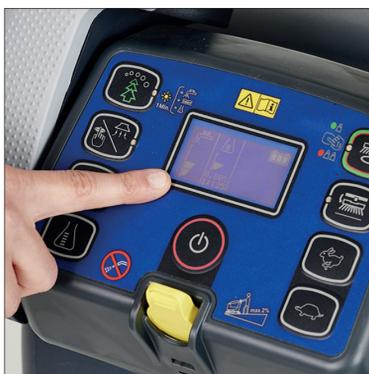
2. Prüfen Sie, ob der Bürstenmotor überlastet ist durch Anzeige: „WARNING ALARM F2“ auf dem Display.
