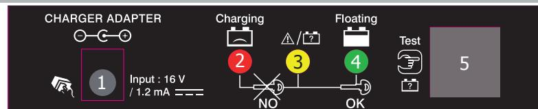
**1** Conexión para el adaptador. Sólo utilizar el cargador de origen entregado con el producto
