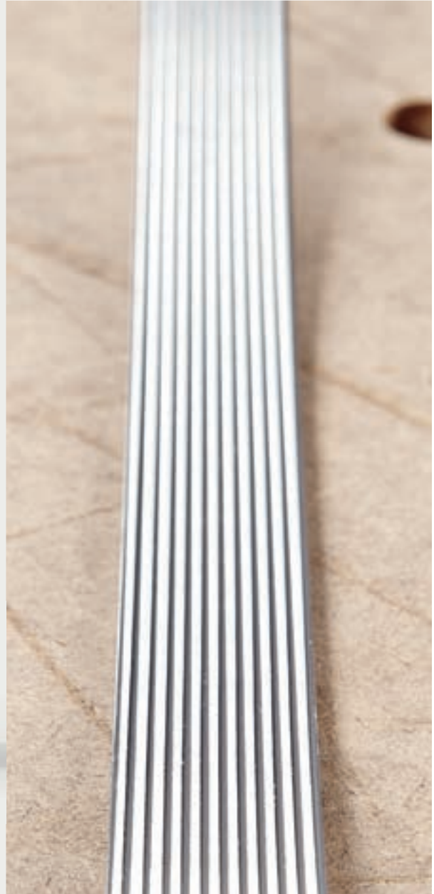
Leimauftrag auf der Kante
