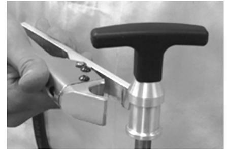
❸ Anschluss der Zange am Handwerkzeug
